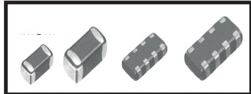
多層片式壓敏電阻器 (MLV) 是一種浪涌電壓抑制器。它是採用先進的疊層片式化技術製造的半導體陶瓷元件，它能為被保護元件（電路）提供強有力的保護，同時具有優良的浪涌能量吸收能力及內部散熱能力。該元件是一種無引線的片式結構，其寄生電感非常小、響應速度非常快（響應時間<0.5ns），因此它具有優良的ESD及各種浪涌噪聲的抑制能力。與傳統的齊納二極管和圓片壓敏電阻器相似，具有體積小、重量輕、響應速度快的特點。
